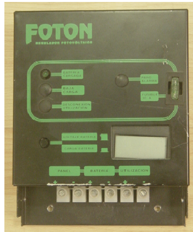
Imagen 4: Vista de un regulador solar FOTON
