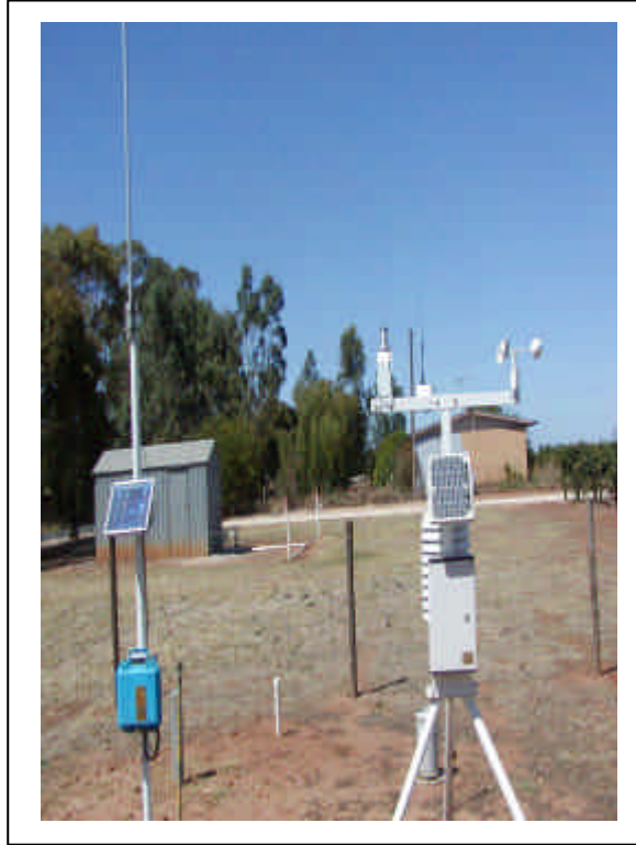
Imagen nº 12 Estación meteorológica + Red de transmisión de datos
